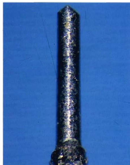
Fig. 6 - Punta della lima diamantata n. 35, nuova (64x).
