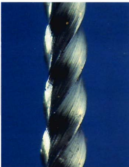
Fig. 3 - Corpo della lima tipo K n. 20, nuova (64x).
