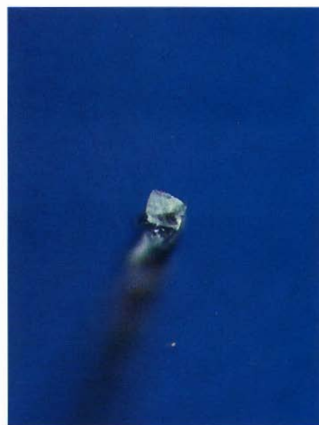
Fig. 13 - Rima di frattura della lima della figura precedente (64x).
