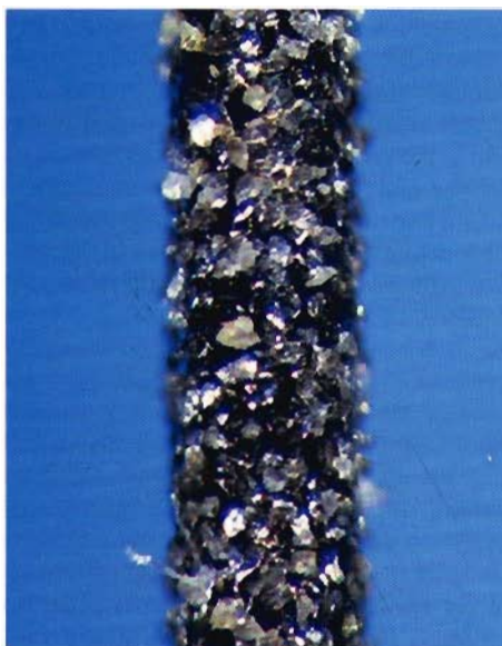
Fig. 5 - Corpo della lima diamantata n. 35, nuova (64x).
