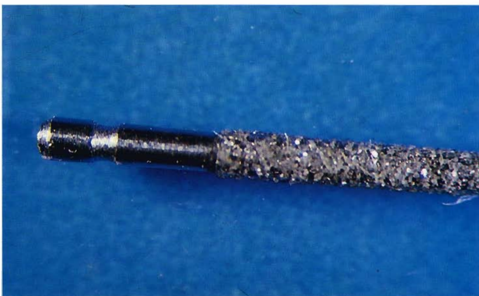
Fig. 11 - Lima diamantata n. 35, usata per 36 canali, fratturatasi all'altezza del gambo.
