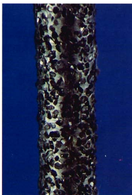
Fig. 9 - Corpo della lima diamantata n. 35, usata per 89 canali. Si noti la perdita dei granuli di diamante (64x).
